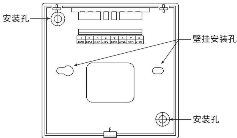
图 4 安装方式示意图
