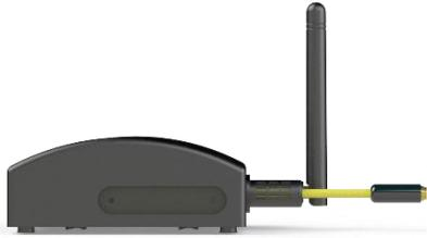
XW-DW101N-M 测漏系统是集监控漏液和无线数据传输为一体的新兴物联网产品。本产品采用最新 NB-IOT 技术，当发生液体泄漏时，控制器会立即上传报警数据到后端平台，提醒监测人员立即处理，实现对液体泄露的实时监测。XW-DW101N-M 测漏系统采用内置电池，待机电流小于 3uA，使用寿命可达 3 年以上。
